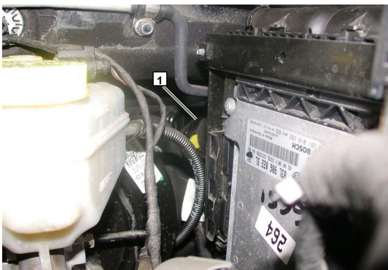
Жгут проводов к отопителю и к 30 клемме АКБ 1 проложить под трубкой кондиционера вдоль левого крыла автомобиля (по ходу движения)
