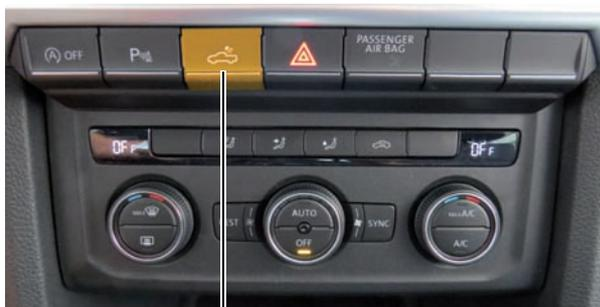
Клавиша освещения багажного отсека
