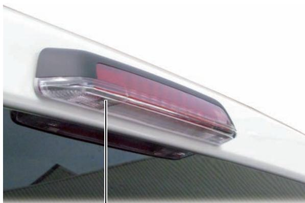
Верхний стоп-сигнал с плафоном освещения багажного отсека
