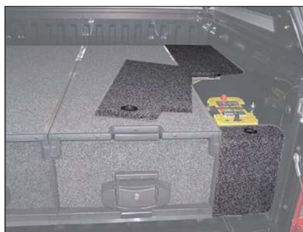
• Abdeckung Schublade seitlich (Abb. zeigt zum Teil abgenommene Abdeckung mit darunter montierter, optionaler Zweitbatterie) Best. Nr. 37-SFKAMAROKFK
