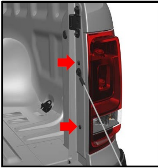
Abb. 4.1.1.1: Ausbau der Schlussleuchten (Abb.1, 2 und 3)
