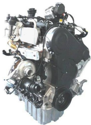
2,0 л Common-Rail с турбонаддувом Monoturbo
